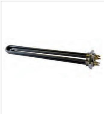
3 épingles en **Incoloy 800** Ø16mm, soudées TIG sur bouchon M77x2 en AISI 304.
