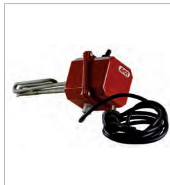
1 épingle en **Incoy 800** Ø8.5mm, brasées sur bouchon M45x2 en laiton. Complet avec boîtier connexions en aluminium verni rouge, classe de protection IP55.
