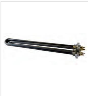
3 épingles en **AISI 316L décapé passivé** Ø16mm, soudées TIG sur bouchon M77x2 en AISI 316L.
