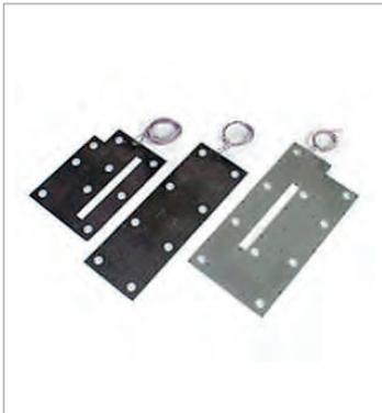
Les résistances plates sont conçues pour le chauffage par conduction. Elles sont rigides, et peuvent être soit en Mica, soit en céramique, avec un blindage en acier galvanisé ou en Inox. Réalisées sur mesure, elles peuvent prendre des formes variées, carrées, rectangulaires, circulaires, etc...
