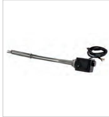
3 épingles en **Incoloy 800** Ø6.25mm, brasées sur bouchon 1"1/2 en Inox AISI 304. Boitier en PVC noir avec **thermostat tripolaire de régulation** 30-75°C, et de sécurité 98°C à réarmement manuel. Sortie en câble Lg 2000mm. Boitier fixé sur bouchon emboutie. Equipé d'un doigt de gant. Tension 400V TRI. NC=49mm.
