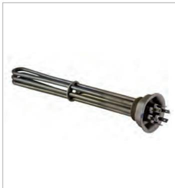
3 épingles en **Inox Aisi 304L** Ø8.5mm, brasées sur bouchon 1"1/2 en AISI 304, plus emboutie pour fixation capot. Equipé d'un doigt de gant. Tension 230/400V TRI. B=44mm. NC=44mm.
