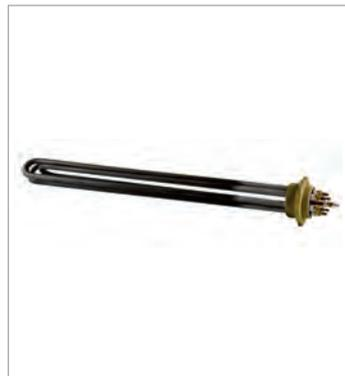
3 épingles en **Incoloy 800** Ø8.5mm, brasées sur bouchon 1"1/2 en laiton, plus M45 pour fixation capot. Tension 230/400V TRI. B=39mm. NC=72mm.
