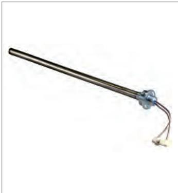
Cartouches pour radiateur horizontal, avec bouchon 1"gaz et 1/2" coté boîtier. Joint viton, thermofusible. Classe 2. Diamètre du tube 16mm, longueur des fils 130mm cossées en drapeau à 90°.
