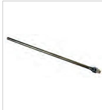
Cartouches pour sèche-serviette, avec bouchon 1/2"gaz. Joint viton. Avec rétreint pour chauffage mixte (électrique ou eau chaude). Montage rapide par connecteurs. Classe 2. Diamètre du tube 16mm, connexion par montage rapide.
