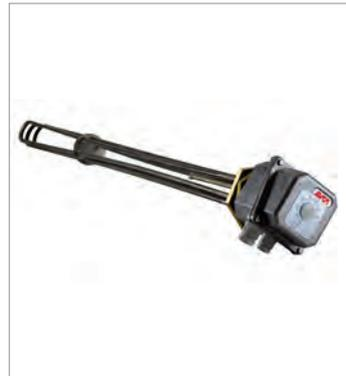
3 épingles en **Incoloy 800** Ø8.5mm, brasées sur bouchon M77x2 en laiton. Complet avec boîtier de connexions en aluminium brut, classe de protection IP55. **Thermostat de régulation** monophasé (pouvoir de coupure 16A maxi, relayage obligatoire si triphasé ou intensité supérieur à 16A) de 4° à 40°C en doigt de gant.
