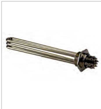
3 épingles en **cuivre nickelé** Ø8.5mm, brasées sur bouchon M45x2 en laiton nickelé.
