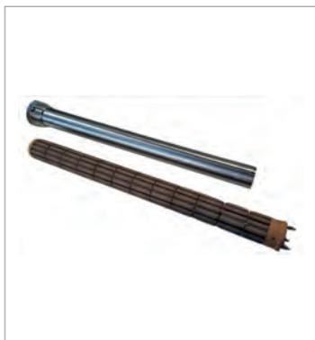
La résistance sur barillets, est composée d'un fil en nickel chrome boudiné et isolé par des composants appelés "barillets", isolant électrique, et conducteur thermique. Les résistances chauffantes sur barillets (dites "Stéatites"), chauffent le fluide au travers d'un doigt de gant dans lequel elles sont montées. On trouve essentiellement ces résistances sur barillets pour le chauffage d'eau chaude sanitaire.
