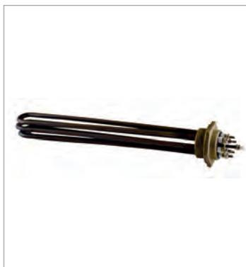
3 épingles en **acier doux** Ø8.5mm, brasées sur bouchon M45x2 en laiton.
