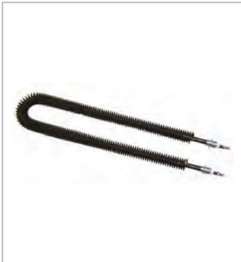
Epingle envirolee (tube  $\varnothing 10\text{mm}$  en Inox AISI 321 – ailettes  $\varnothing 28\text{mm}$  en Inox AISI 430). Largeur d'entre-axe des ailettes 5.2mm, largeur d'entre-axe des connexions 65mm. Manchons de fixations en acier zingués M15 x 1 avec joint en Asbérít. Connexions électriques en bornes filetées M6.
