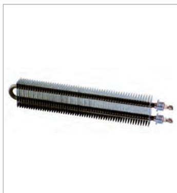
Epingle Ø12.5mm (tube en Inox AISI 304 – ailettes 40x80 en Inox AISI 430). Largeur d'entre-axe des ailettes 7mm, largeur d'entre-axe des connexions 40mm. Manchons de fixations en acier zingué M24 x 1.25 avec joint en Asbérit. Connexions électriques en bornes plates avec étriers. Température maxi d'utilisation jusqu'à 250°C. NC=59mm.
