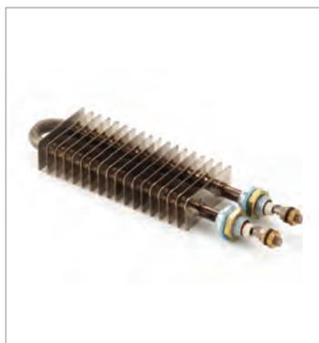
Epingle Ø8.5mm (tube en Inox AISI 304 – ailettes 25x50 en Inox AISI 304). Largeur d'entre-axe des ailettes 7mm, largeur d'entre-axe des connexions 25mm. Manchons de fixations en acier zingué M14 x 1.5 avec joint en Asbérit. Connexions électriques en bornes filetées M6. Température maxi d'utilisation jusqu'à 250°C. NC=39mm.
