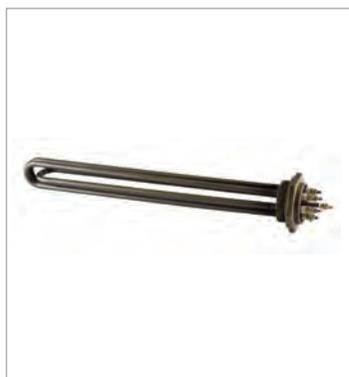
3 épingles en **Incoloy 825** Ø12.5mm, brasées sur bouchon M77x2 en laiton.
