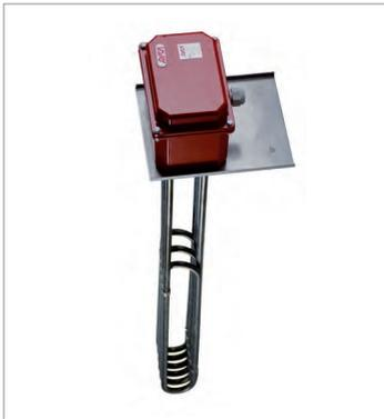
3 épingles en **Incoloy 800** Ø10mm, soudées TIG sur bride. Montage vertical sur le bord de la cuve. Platine pour le montage en inox AISI 304. Boitier en aluminium peint époxy. Tension 230/400 TRI. NC=350mm.
