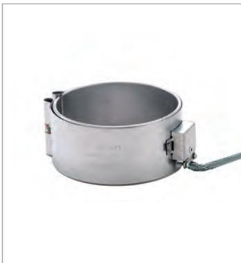
Les colliers chauffants sont conçus pour le chauffage par conduction de pièces cylindriques. Ils sont rigides, et peuvent être soit en Mica, soit en céramique, avec un blindage en acier galvanisé ou en Inox.
