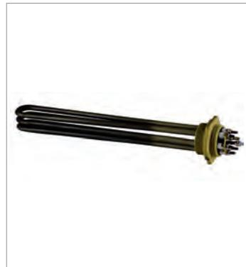
3 épingles en **Incoy 304** Ø8.5mm, brasées sur bouchon M45x2 en laiton.
