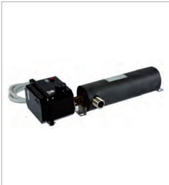
Corps en Inox AISI 304 calorifugé Armaflex. Éléments chauffants en **Incoloy 800**. Entrée et sortie fluide 1" femelle. Boîtier en aluminium IP55 peinture époxy. Thermostat de régulation plage 30-75°C, et de sécurité 98°C. Câble de raccordement 3 x 2.5mm<sup>2</sup> longueur 2m.
