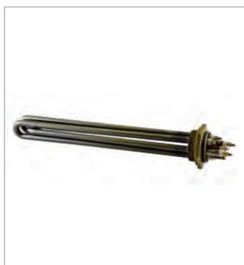
3 épingles en Inox **AISI 321** Ø16mm, brasées sur bouchon M77x2 en laiton.
