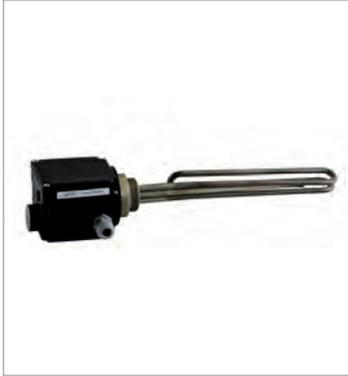
1 épingle en **Incoloy 800** Ø8.5mm, brasées sur bouchon 1"1/2 en Inox AISI 304. Boitier en PVC noir avec **thermostat bipolaire de régulation** 30-70°C, et de sécurité 90°C à réarmement manuel. Sortie par câble Lg 2000mm. Boitier fixé sur bouchon emboutie. Equipé d'un doigt de gant. Tension 230V MONO. A=320mm. NC=42mm.
