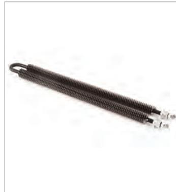
Epingle envirolee (tube  $\varnothing 12.5\text{mm}$  en Inox AISI 321 – ailettes  $\varnothing 30.5\text{mm}$  en Inox AISI 304). Largeur d'entre-axe des ailettes 6.2mm, largeur d'entre-axe des connexions 40mm. Manchons de fixations en acier zingués M24 x 1.25 avec joint en Asbérít. Connexions électriques en bornes plates avec étriers.
